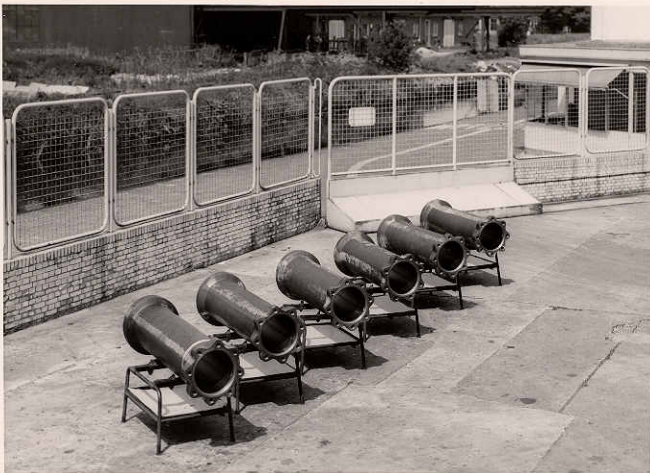
VANUIT RUWE GIETSTUKKEN GEHEEL DOOR ENKES BEWERKTE CILINDERS GETEST OP 200 ATM. DRUK
